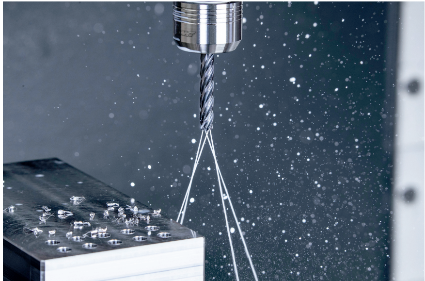
In so gut wie allen Leistungsparametern soll er neue Maßstäbe setzen: der VHM-Hochvorschubbohrer mit der Bezeichnung WTX HFDS (© Ceratizit)
